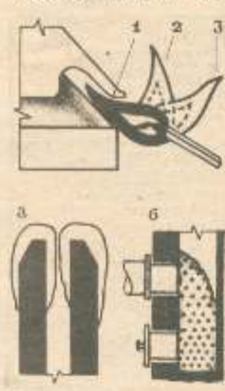
1 — тяга є; 2 — тяги немає; 3 — тяга дворотка. ПРИЧИНИ ПОРУШЕННЯ ТЯГИ: а) замерзання голівки; б) засмічення димоходу.
